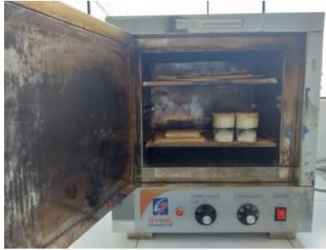
Figura 15. Esterilización de los instrumentos para la realización de la actividad antibacteriana, se sometió a una temperatura 40 grados. Fuente: Propia
