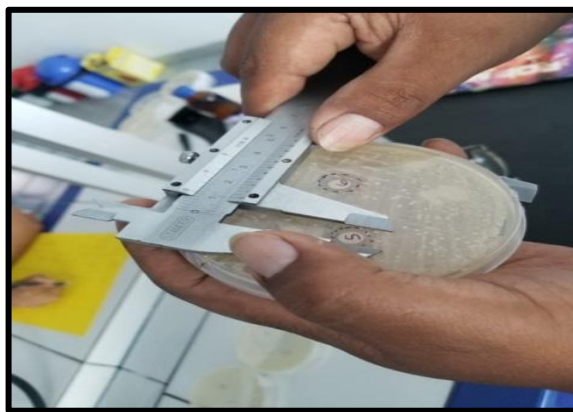
Figura 33. Muestra la medición de los halos con el instrumento vernier del laboratorio de Farmacia y bioquímica de UNID. Fuente propia
