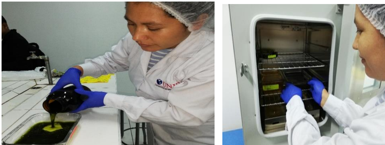
Figura 37 .El macerado de las hojas de Achyrocline alata (Kunth) DC. “Árnica” se vierte en envase de pírrex para llevar al horno 40 grados de 3 a 4 días. Fuente Autor. Imagen propia
