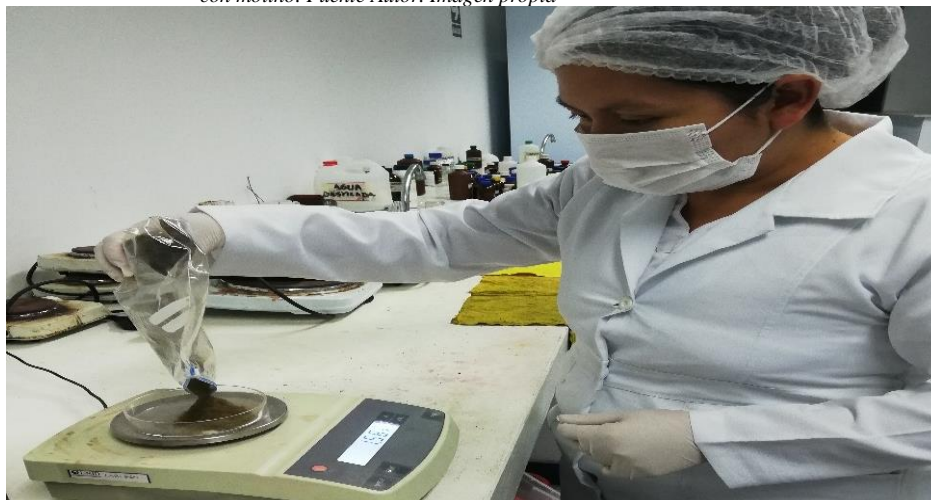
Figura 35. Peso de las hojas de Achyrocline alata (Kunth) DC. “Árnica” on molino pulverizadas para luego macerar por una semana en metanol. Fuente Autor. Imagen propia.
